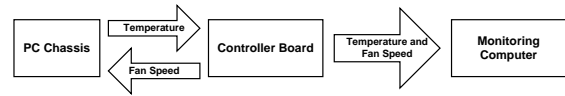
รูปที่ 1 ส่วนประกอบหลักของอุปกรณ์ทดลองด้านฮาร์ดแวร์
