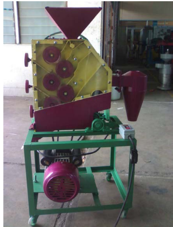
รูปที่ 1 ชุดทดลองเครื่องสีข้าวกลองขนาดเล็ก
