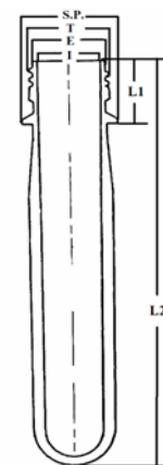
รูปที่ 2 การวัดขนาดของหล่อดพรีฟอร์ม ที่มา (บริษัท เพชรแพค จำกัด)
