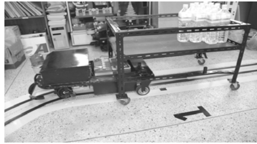
รูปที่ 6 การปลดตะขอเกี่ยวกระบะบรรทุกเมื่อถึงสถานี ปฏิบัติงาน
