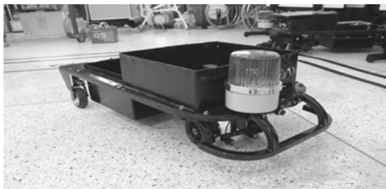
รูปที่ 4 ตัวรถที่ใช้เหล็กกล่องทำเป็นโครงสร้าง
