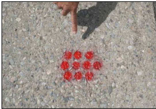
รูปที่ 3 การกำหนดจุดมาตรฐานจากแผ่นแข็งเจาะรูแล้วพ่นสี [12]
