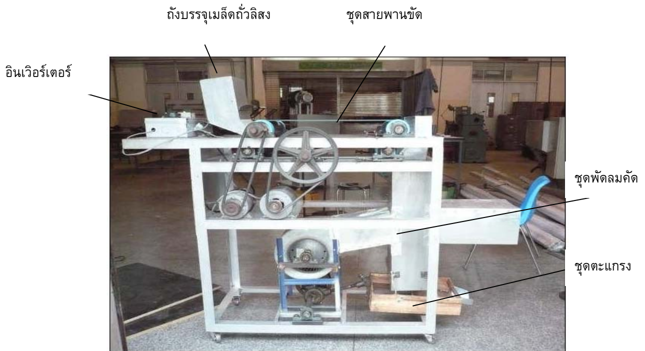
รูปที่ 4 แสดงด้านข้างเครื่องต้นแบบสำหรับขัดผิวถั่วลิสง
