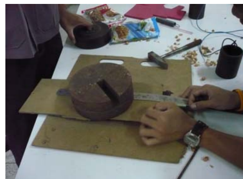
รูปที่ 2 แสดงลักษณะผิวของสายพาน Grip VIO
