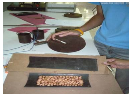
รูปที่ 3 แสดงการทดสอบหาค่าความเค้นเฉือนวิกฤติ สำหรับสีผิวถั่วลิสง
