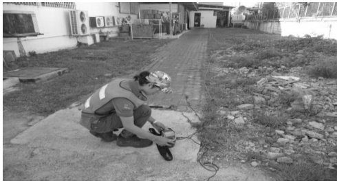
ภาพที่ 2 ภาพแสดงการตรวจวัดค่าความต้านทานดิน
