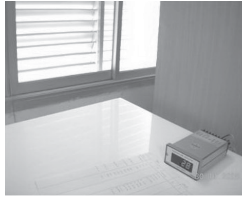
ภาพที่ 9 แสดงอุปกรณ์ Thermo-couple ที่ใช้วัดค่าอุณหภูมิ ภายนอกและภายในห้องสมุด (วันที่ 30 ตุลาคม พ.ศ. 2551)
