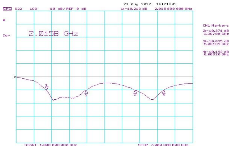
ภาพที่ 15 วัดค่าอิมพีแดนซ์แบนด์วิดท์ของสายอากาศร่องประกบรูปสี่เหลี่ยม [a]
