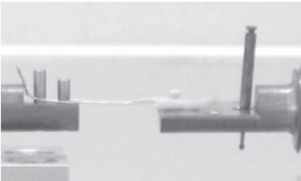
รูปที่ 2 แสดงการจัดวางตัวอย่างเพื่อทดสอบแรงความแข็งแรงยึดติดจุดภาคแบบเฉือน
