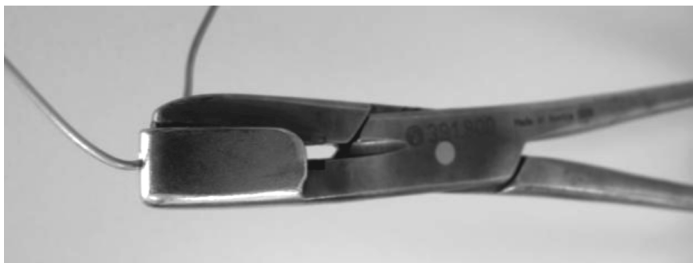
ภาพที่ 8 แสดงบริเวณปากที่ใช้จับลวดของ holding forcep
