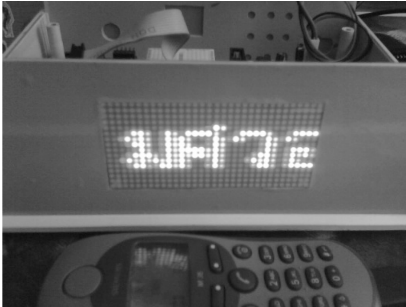
ภาพที่ 6 แสดงผลการทดสอบซึ่งแสดงค่าข้อความ “มศววงศรักรักษ์” ที่ส่งมาแสดงผล
