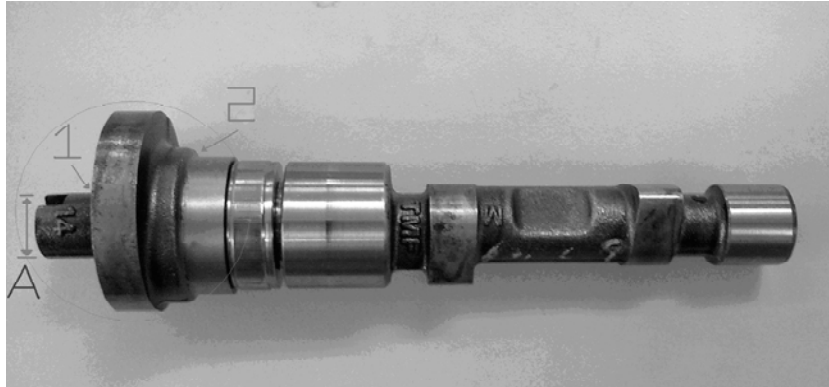
ภาพที่ 1 แสดงการปรับแต่งเพลาลูกเบี้ยวเพื่อเปลี่ยนองศาการฉีดเชื้อเพลิง
