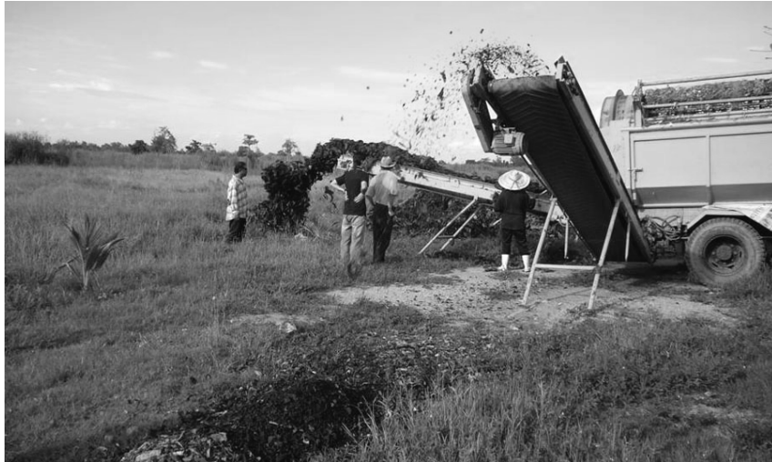
ภาพที่ 2 การร่อนขยะพลาสติกจะขยะที่ผ่านการย่อยสลายด้วยวิธีการทางชีวภาพ
