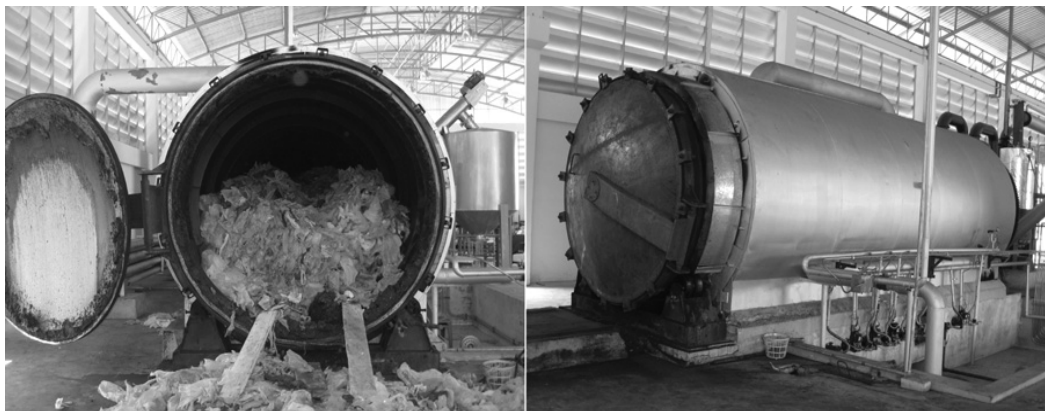
ภาพที่ 7 การป้อนขยะพลาสติกเข้าสู่เครื่องปฏิกรณ์ไพโรไลซิสกำลังการผลิต 6 ตันต่อวัน
