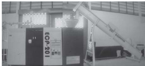
ภาพที่ 2 เครื่องจักรแปรรูปขยะเป็นน้ำมัน
