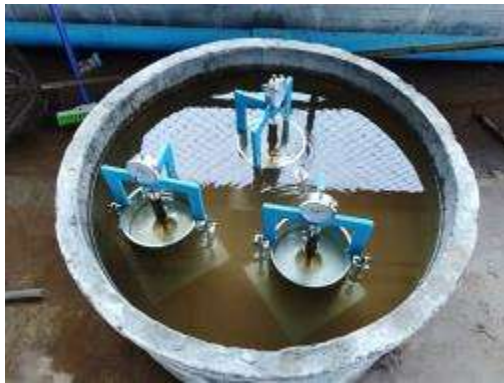
ภาพที่ 2 การทดสอบ C.B.R. แบบแช่น้ำ
