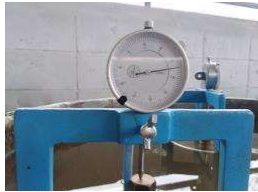
ภาพที่ 2 การทดสอบ C.B.R. แบบแช่น้ำ
