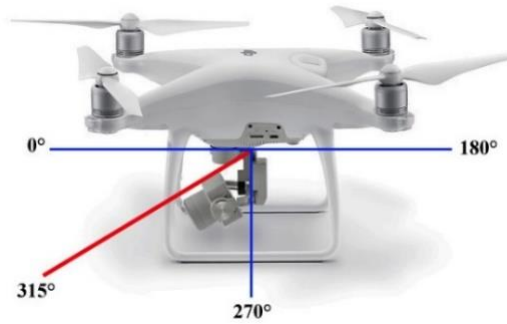
ภาพที่ 4 การกำหนดมุมกล้องทำมุม 135 องศาพื้นฐานติดตั้งกับตัวโดรน
