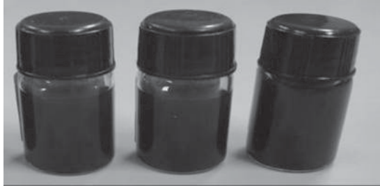
ภาพที่ 9 สารละลายไคโตซานที่ผสมท่อนาโนคาร์บอนชนิด CNT-S 5%, 10% และ 15% (w/w ของ CNT ต่อไคโตซาน)
