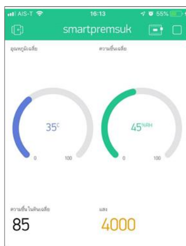
ภาพที่ 10 แอปพลิเคชัน บลิงค์ (Blynk) เพื่อใช้ตรวจสอบสภาพแวดล้อมภายในโรงเรือนจากอินเทอร์เน็ต
