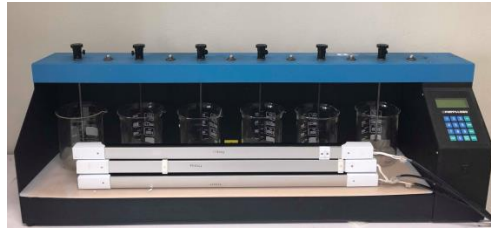
ภาพที่ 2 ติดตั้งอุปกรณ์กับเครื่องจาร์เทสต์
