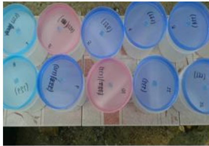
ภาพที่ 1 การเตรียมหัววัด CR – 39 พร้อมกำกับหมายเลข
