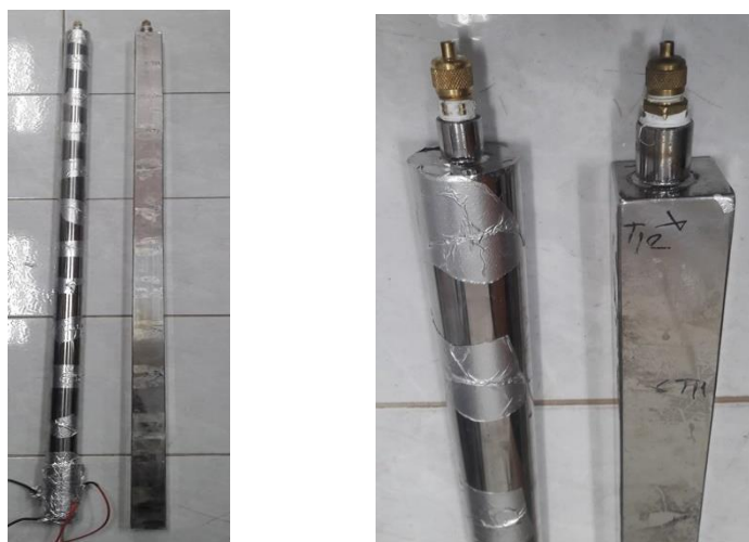
(ก) ลักษณะของท่อเทอร์โมไซฟอนที่ใช้ในการทดลอง (ข) ภาพหน้าตัดท่อเทอร์โมไซฟอนทั้งสองแบบ
