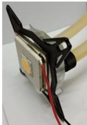
ภาพที่ 2 การประกอบหลอดแอลอีดีกับแผ่นเทอร์โมอิเล็กทริกและอุปกรณ์ระบายความร้อนด้วยน้ำ
