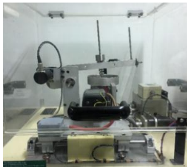
ภาพที่ 5 แสดงเครื่องทดสอบการสึกแบบจานและหมุด (Wear Tester Model TE79 Pin on Disk)
