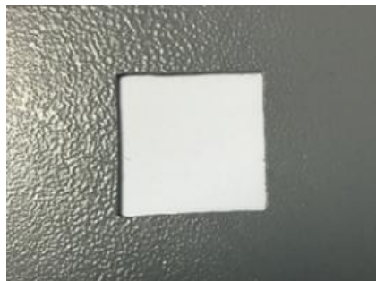
ภาพที่ 4 แสดงบล็อกที่ทำจากแผ่นเหล็ก โดยเจาะรูตรงกลางขนาด 3 \times 3 เซนติเมตร หนา 1 มิลลิเมตร เพื่อยึดเคลือบฟันด้วยอะคริลิกสีใส
