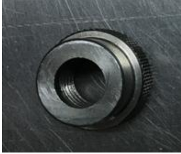
ภาพที่ 7 แสดงลักษณะตัวจับทรงกระบอก เส้นผ่านศูนย์กลาง 8 มิลลิเมตร
