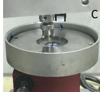
ภาพที่ 8 A. แสดงการนำแท่งทองเหลืองใส่ในตัวจับทรงกระบอกเส้นผ่านศูนย์กลาง 8 มิลลิเมตร สูง 23 มิลลิเมตร และยึดกับวัสดุบูรณะฟันที่ขึ้นรูปด้วยแคดแคมแบบพินส์ด้วยนอต B. นำแท่งทองเหลืองใส่ในตัวจับทรงกระบอก C. นำตัวจับทำการยึดกับเครื่องทดสอบการสึก
