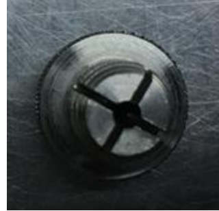
ภาพที่ 7 แสดงลักษณะตัวจับทรงกระบอก เส้นผ่านศูนย์กลาง 8 มิลลิเมตร
