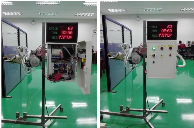
ภาพที่ 5 การติดตั้งอุปกรณ์ตรวจสอบและควบคุมข้อมูลหน่วยความจำของพีแอลซีกับเครื่องขยับข้อต่อเนื่องของข้อตอกและหัวไหล
