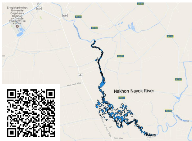
ภาพที่ 9 Flood Inundation Map สำหรับแม่น้ำนครนายก ช่วงตำบลบางลูกเสือ (QR Code เชื่อมไปไฟล์ภาพเคลื่อนไหว หรือ Animation File)
