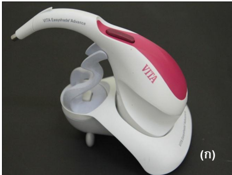
ภาพที่ 2 (ก) เครื่องวัดสีวีต้าอีซีแอดวานซ์ (ข) การวัดสีด้วยเครื่องโดยทำซิลิโคนเป็นแนวนำแสง
