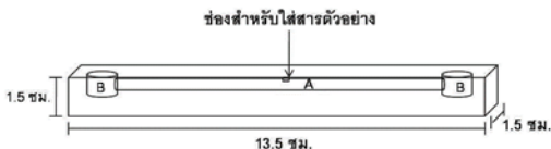
ภาพที่ 1 ลักษณะด้านข้างของอุปกรณ์อิเล็กโทรโฟรีซิสขนาดเล็กที่ทำจาก PDMS
