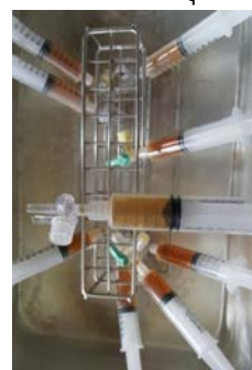
(จ) อุณหภูมิกับสมดุลของ \text{NO}_2 กับ \text{N}_2\text{O}_4
