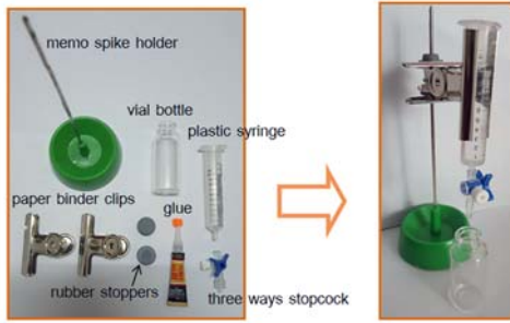
ภาพที่ 1 วัสดุ/อุปกรณ์ที่ใช้ในการไทเทรตอย่างง่ายแบบย่อส่วนและต้นทุนต่ำ
