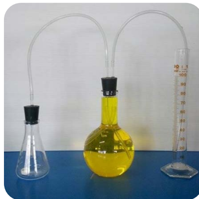
ภาพที่ S3 การจัดอุปกรณ์การทดลองโดยอาศัยการแทนที่แก๊สด้วยน้ำ
