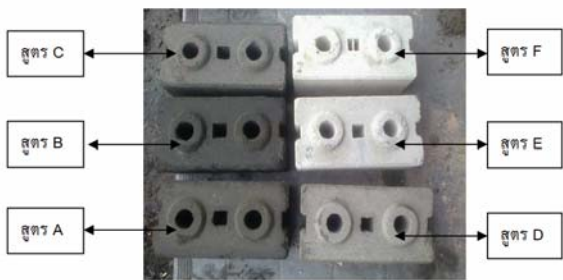
ภาพที่ 3 อิฐบล็อกประสานขนาด 12.5×25×10 cm หลังจากการบ่ม 28 วัน
