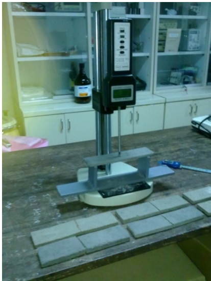
ภาพที่ 1 ทดสอบมอดูลัส (Force Gauge) รุ่น FG-20 KG -232
