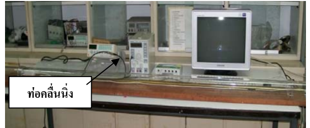
ภาพที่ 2 ชุดทดลองหาค่าสัมประสิทธิ์การดูดซับเสียงโดยเทคนิคท่อคลื่นนิ่ง
