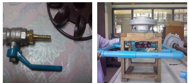
ภาพที่ 3 เครื่องกำเนิดไฟฟ้าพลังงานน้ำขนาดเล็กแบบหัวฉีดอย่างง่ายจากมอเตอร์เครื่องซักผ้าที่ติดตั้งและทดสอบ ณ ต.กาลอ อ.รามัน จ.ยะลา
