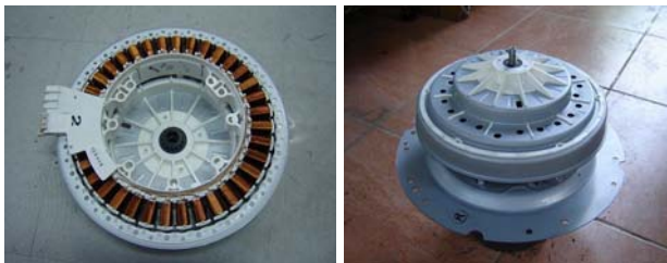
ภาพที่ 1 มอเตอร์เครื่องซักผ้ายี่ห้อโตชิบา รุ่น S-DD Generator
