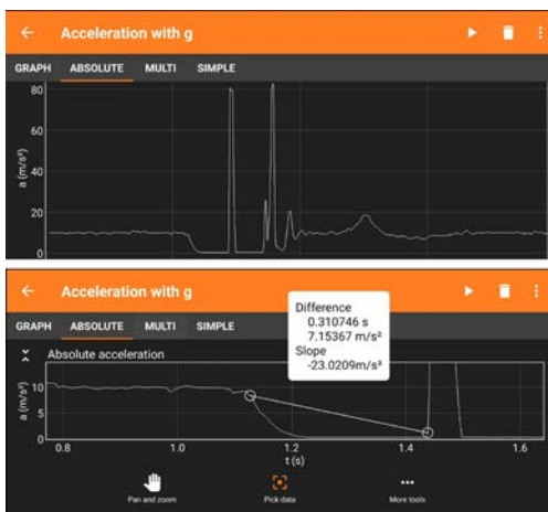
ภาพที่ 3 ชุดทดลองการตกอิสระโดยประยุกต์ใช้ฟังก์ชัน acceleration with g
