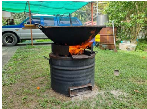
ภาพที่ 4 การทดสอบสมรรถนะของเตาชีวมวลชนิด TLUD โดยใช้วิธี water boiling test
