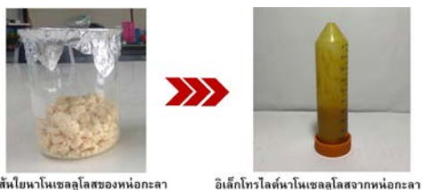
ภาพที่ 2 ลักษณะของผงเส้นใยนาโนเซลลูโลสจากหน่อกล้วย (ซ้าย) และสารอิเล็กโทรไลต์นาโนเซลลูโลส (ขวา)
