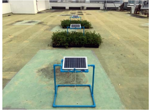
ภาพที่ 6 แบบจำลองการศึกษาประสิทธิภาพการผลิตพลังงานไฟฟ้าของเซลล์แสงอาทิตย์
