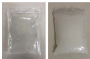
ภาพที่ 4 การเปลี่ยนแปลงลักษณะทางกายภาพของแผ่นเจลแบ่งมันสำปะหลัง สูตร N7 เมื่อผ่านการใช้งานสำหรับประคบร้อนและเย็นไม่ต่ำกว่า 5 รอบ (ไป-กลับ)
