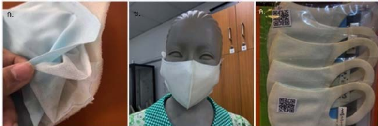
ภาพที่ 2 (ก) การประกอบตัวหน้ากาก (ข) ตัวอย่างของหน้ากากป้องกันฝุ่นที่พัฒนาขึ้น (HOMESWU 01) และ (ค) ต้นแบบหน้ากากป้องกันฝุ่นละอองในบรรจุภัณฑ์สำหรับสำรวจความพึงพอใจของผู้บริโภค
