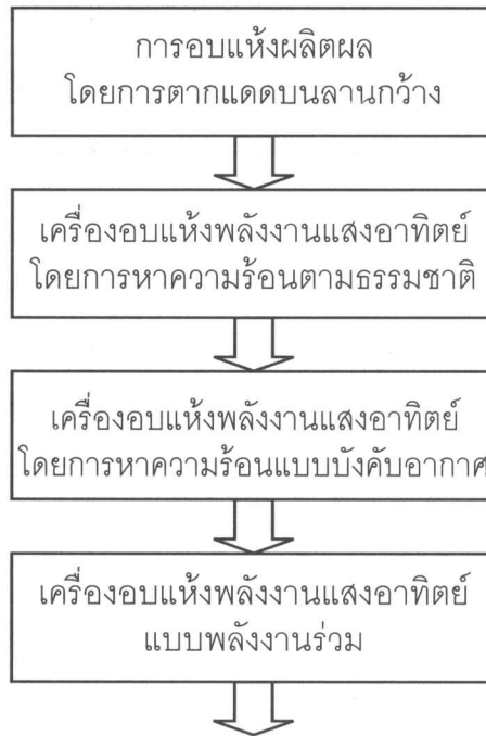
รูปที่ 1 แสดงขั้นของวิวัฒนาการเครื่องอบแห้งผลิตผลโดยใช้พลังงานแสงอาทิตย์
