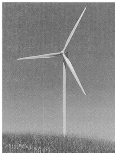
ภาพประกอบ 10 กังหันลมชนิดแกนใบพัดอยู่ในแนวระนาบ
